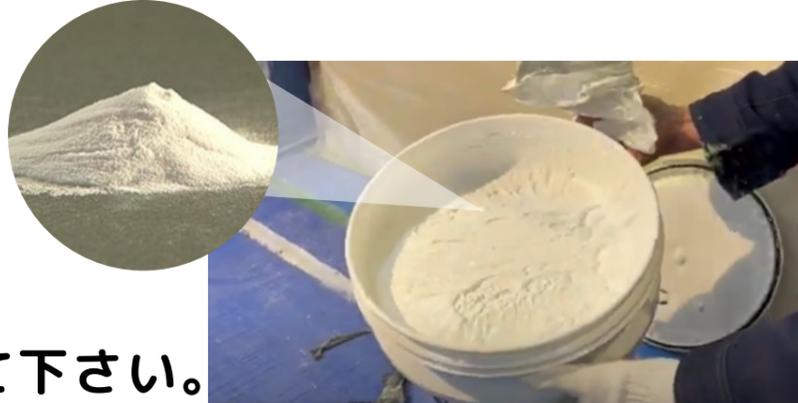
⚠ 攪拌する際は必ず**攪拌機**を使用して下さい。
