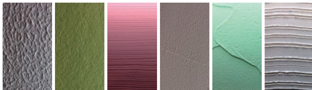
▲ローラー仕上げ ▲吹付仕上げ ▲刷毛仕上げ ▲コテ仕上げ ▲コテ仕上げ ▲撥引仕上げ
