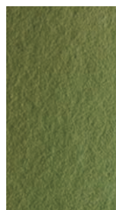
▲ローラー仕上げ
